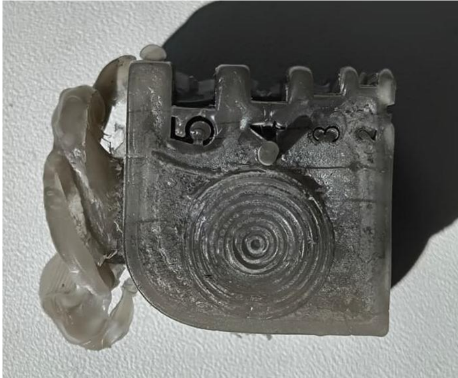
Exemplu de piesa injectata utilizat ca dovada de proces.
